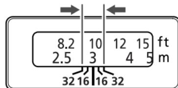
Глубина резкости – это диапазон пространства (расстояния) спереди и сзади плоскости фокуса на объекте, которое изображается резким. Глубина резкости обозначается зоной между линиями на шкале глубины резкости под шкалой расстояний.
