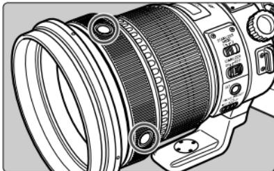
Во время выполнения autofокусировки можно нажать кнопку AF stop, чтобы временно остановить работу autofокусировки. Если в момент, когда вы отпустили кнопку AF stop, кнопка спуска затвора была все еще нажата наполовину, выполнение autofокусировки продолжится.
