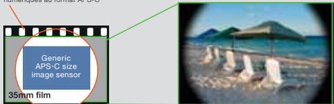
La dimension d'un capteur au format APS-C ne couvre pas le format 24x36.
