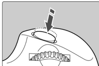
**3** При нажатии кнопки спуска наполовину функция стабилизатора изображения начинает работу.
