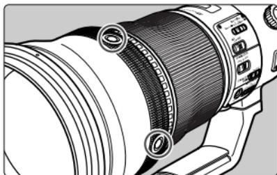
Во время выполнения автофокусировки можно нажать кнопку AF stop, чтобы временно остановить работу автофокусировки. Если в момент, когда вы отпустили кнопку AF stop, кнопка спуска затвора была все еще нажата наполовину, выполнение автофокусировки продолжится.
