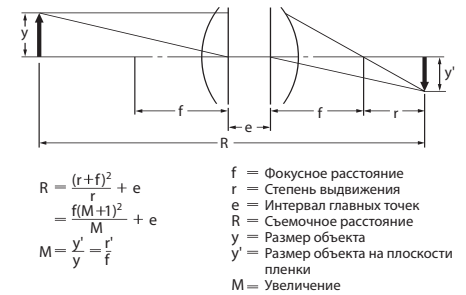
Рис. 39. Взаимосвязь между фокусным расстоянием, степенью выдвигания (всего объектива) и увеличением
