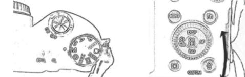
• Фотокамеры Samsung NX автоматически изменяют выдержку в зависимости от величины диафрагмы, если диск управления установлен в положение «A». Диафрагму можно изменять вращением диска управления диафрагмой. При этом не требуется выбирать выдержку вручную, как в режиме «M».
