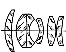
Рис. VII, 4. Схема особо светосильных проекционных анастигматов РО-109, РО-110 и РО-111
