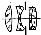
Рис. IV, 8. Оптическая схема объектива «Тессар»
