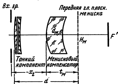
Рис. IV, 15. К расчету телеобъективов типа «Таир»
