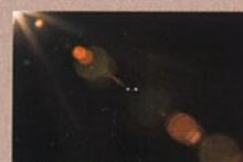
**Пример бликообразования в объективе среднего качества от постороннего производителя. Видна характерная картина многочисленных бликов в форме отверстия диафрагмы и общей засветки кадра — результат некачественного просветления линз и плохого чернения внутренних поверхностей**
