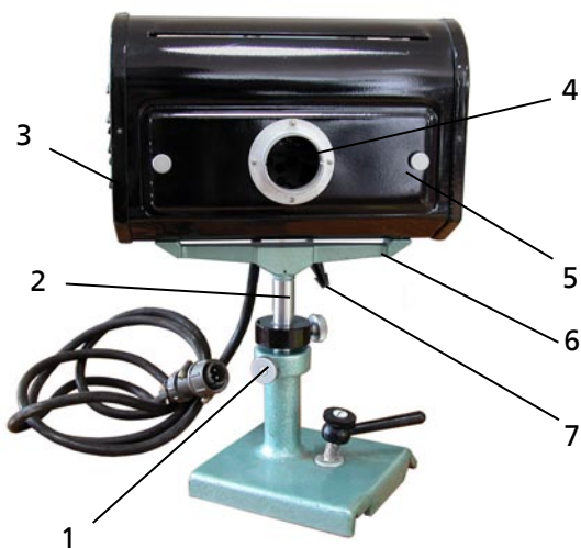
Рисунок 16 – Общий вид осветителя с ртутно-кварцевой лампой ДРТ240
